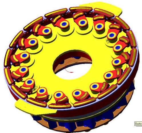
Fig. 4 Modelul 3D pentru mecanismul aparatului director importat în ADAMS; cupla C, simulare 3D.
